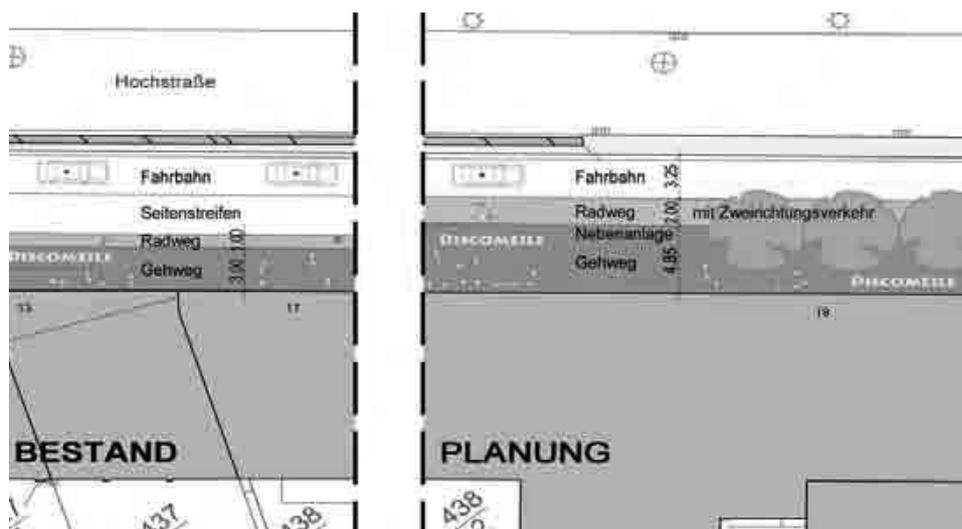
Neben einer Verbreiterung des Gehwegs zugunsten von mehr Sicherheit und einer größeren Aufenthaltsqualität kann mit dieser Querschnittsänderung auch die Situation für den Radverkehr deutlich verbessert werden. Städtebaulich wird diese Lösung, die der Bebauung mit ihrer hoch frequentierten Nutzung eine üppig dimensionierte ebene Vorfläche zuordnet, positiv bewertet.
