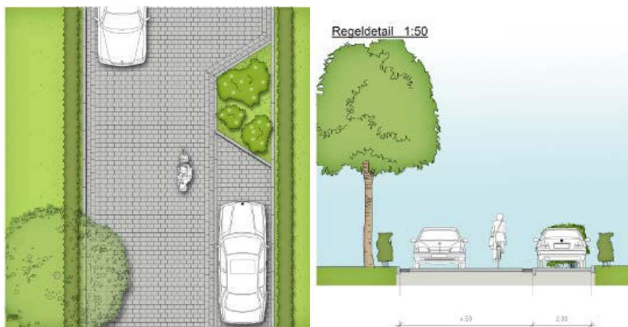
Abbildung 3: Regeldetails aus dem Freiraumkonzept, Originalmaßstab rechts 1 : 50 (Kreikenbaum und Heinemann, Bremen)
