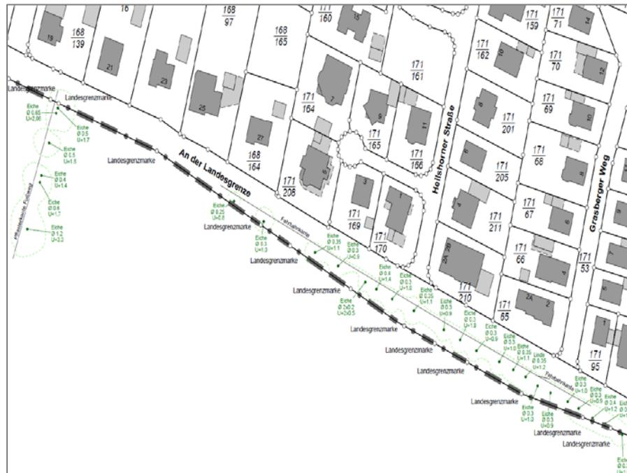
Abbildung 6: Lageplan Baumaufmessung, Quelle: Bruns Vermessung, Osterholz-Scharmbeck
