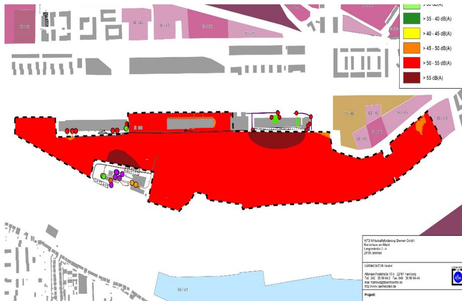
Abbildung 8: Anlage 2b: Schallimmissionsplan Gewerbe (Berechnungshöhe 5,4m) Vollers Teelogistik & Rickmers Reismühle – Beurteilungspegel – Nacht
