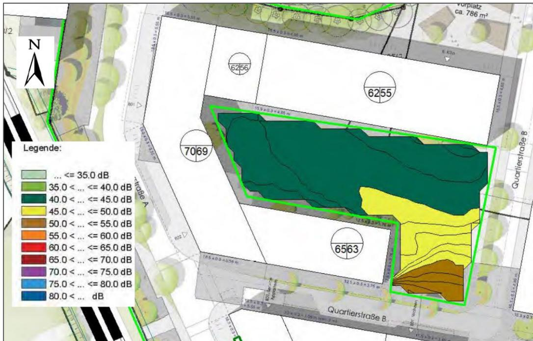
Abb. 10: Immissionsraster für den Verkehrslärm auf der geplanten Außenspielfläche der Kita, Immissionshöhe 1,2 m (Quelle: T+H Ingenieure)
