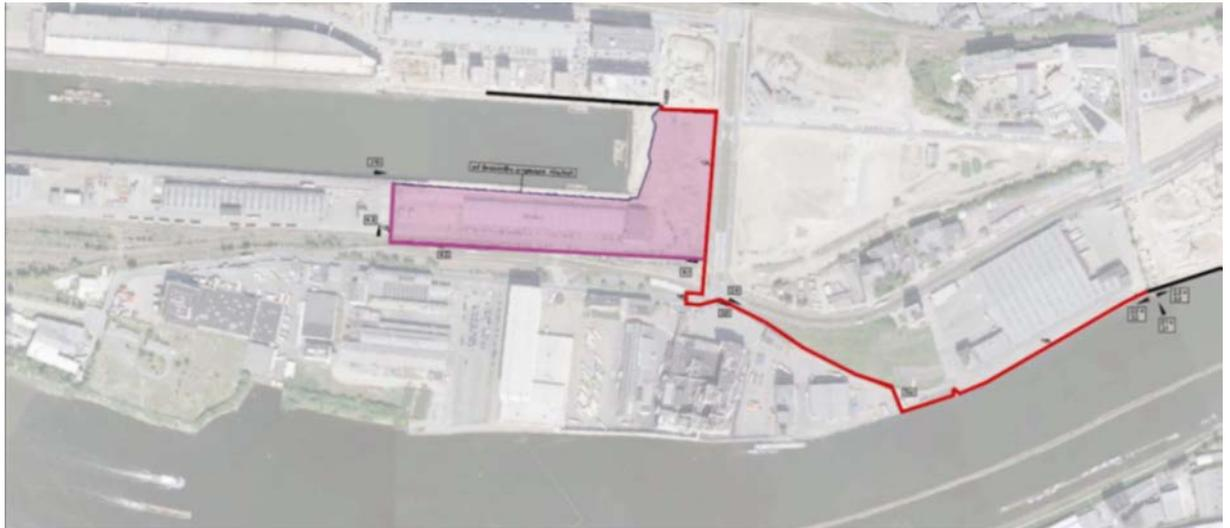
**Abb. 46 : Hochwasserschutzlinie (Quelle. Rahmenentwurf Südseite Europahafen)**
